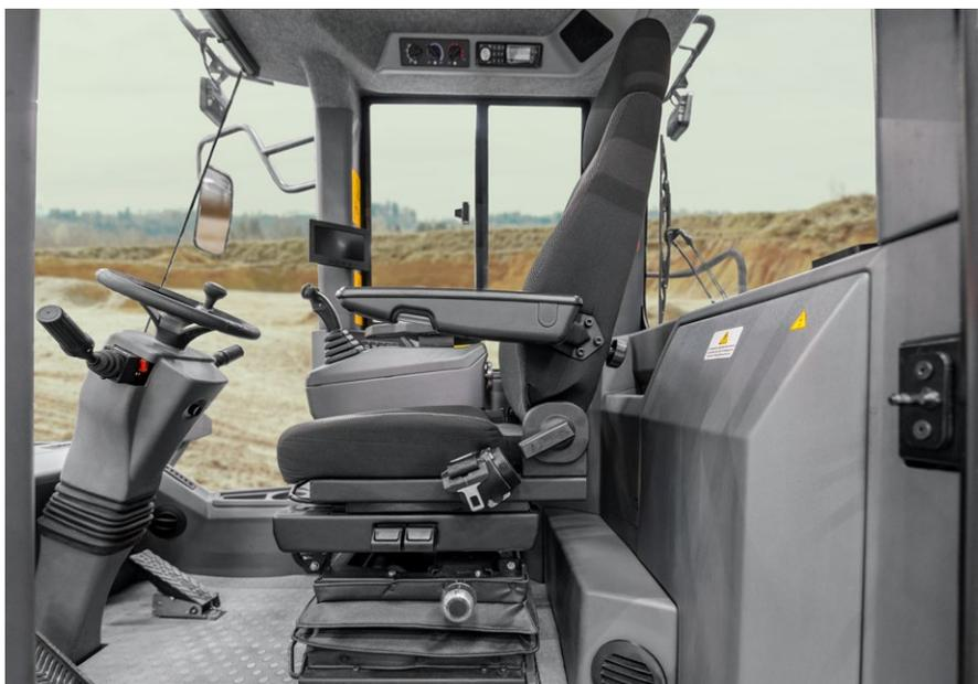
**Рулевое колесо** регулируется по высоте и углу наклона, позволяя выбрать оптимальное положение.
