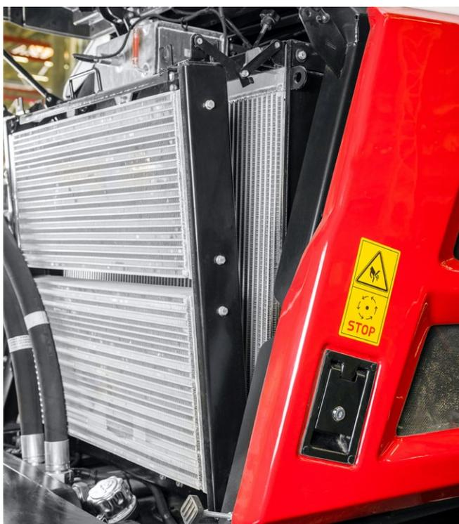
Система охлаждения секционная. **Внешняя секция радиатора откидывается**, обеспечивая доступ к внутренней секции.
