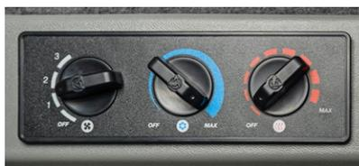
Погрузчик оснащается **кондиционером и отопителем**.
