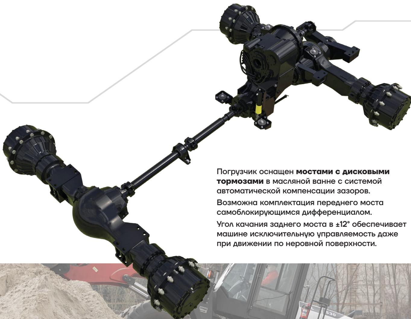
Погрузчик оснащен **мостами с дисковыми тормозами** в масляной ванне с системой автоматической компенсации зазоров.
