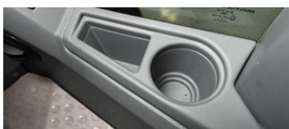
В кабине организовано **множество мест для хранения**: два закрывающихся отсека, один из которых оснащен системой обогрева и охлаждения, две открытые ниши, два подстаканника и отсек для документов за креслом оператора.
