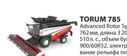
**TORUM 785 Advanced Rotor System**, диаметр ротора 750 мм, длина 3200 мм, двигатель ЯМЗ, 510 л. с., объем бункера 12000 л, ширина захвата 6 м, автоматическое управление центральным зернораспределением, жатка агрегатируется с комбайнами TORUM 750, ACROS, VECTOR, NOVA, ширина захвата 4/5/6/7/9 м
