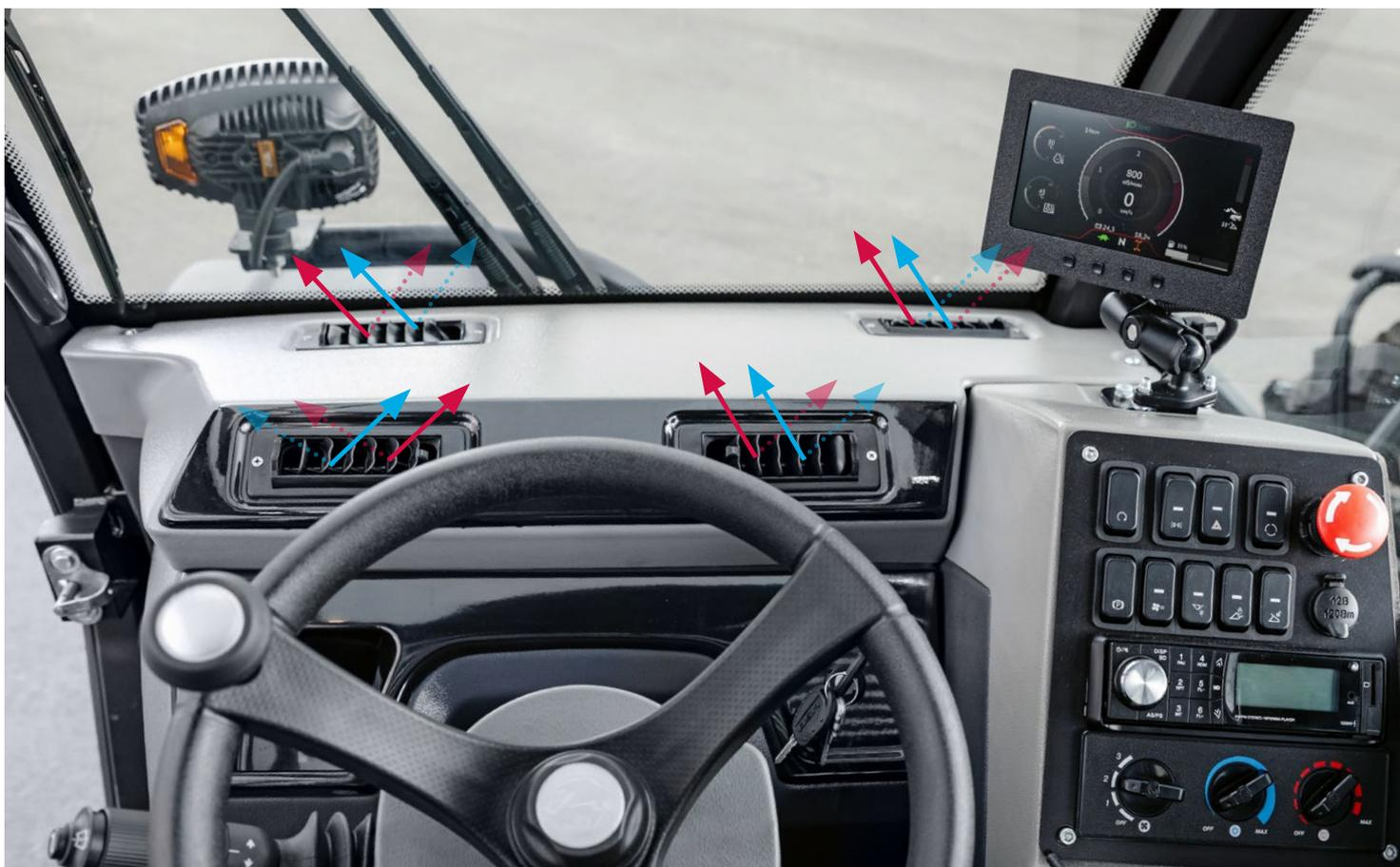
**Система микроклимата** обеспечивает создание комфортных условий для оператора в герметизированной кабине.
