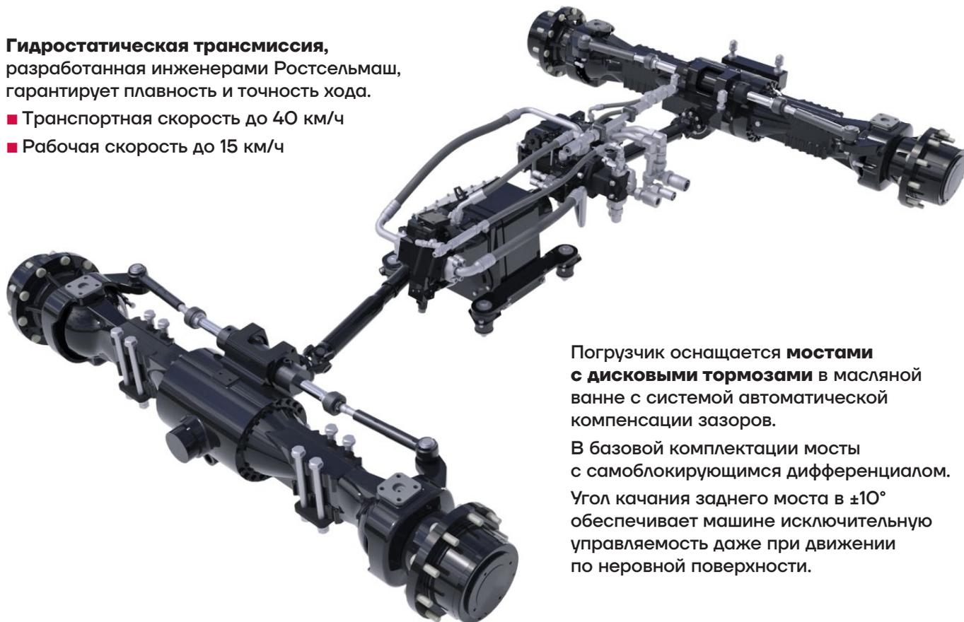
Погрузчик оснащается **мостами с дисковыми тормозами** в масляной ванне с системой автоматической компенсации зазоров.
