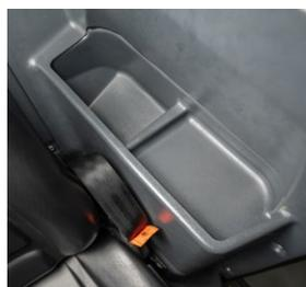
**Система хранения** позволяет удобно разместить необходимые оператору вещи. Включает в себя расположенный за сиденьем охлаждаемый бокс, закрываемый отсек в подлокотнике, открытые ниши для малогабаритных предметов.
