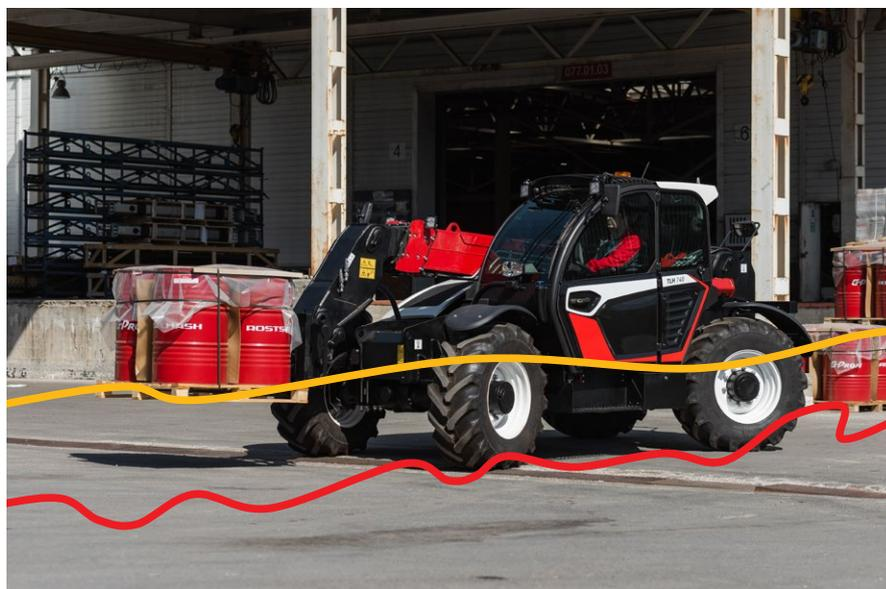
Для увеличения производительности работ погрузчик оснащается **системой активного демпфирования стрелы**, которая обеспечивает снижение амплитуды колебаний ковша при движении с грузом, что позволяет повысить скорость работы и сократить просыпание материала.
